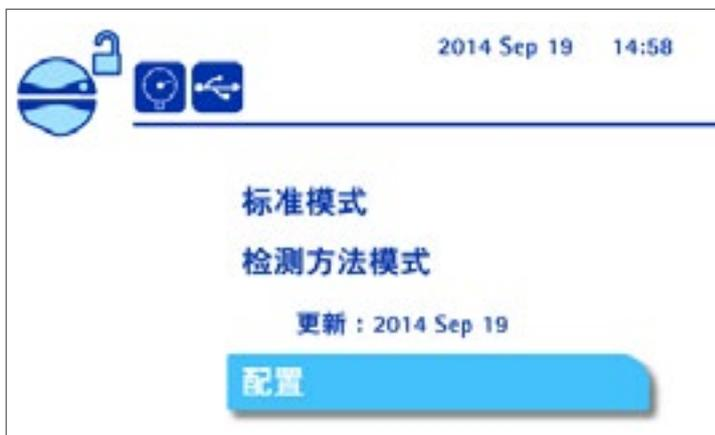
2. 旋转并按压控制钮选择配置。这时将显示配置菜单画面。
