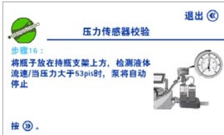
将瓶子倒置放在瓶架中。
